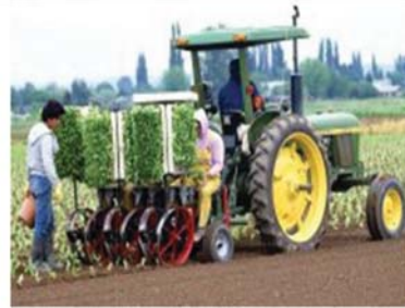
نظام زراعة الشتلات الأوتوماتيكي المستخدم في أمريكا الشمالية (مثال على زراعة آلية باهظة الثمن بهدف خفض تكاليف اليد العاملة وزيادة الإنتاج)
